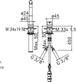
Requer orifício duplo; um deles pode ser em substituição do comando da válvula automática. Distância máxima de 500 mm entre misturadora e comando.
