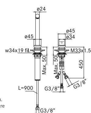
Requer orifício duplo; um deles pode ser em substituição do comando da válvula automática. Distância máxima de 500 mm entre misturadora e comando.
