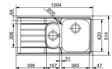
Nas instalações à face, é necessário perfurar o orifício e fazer o rebaixamento com base nas medidas/espessura do lava-loiças a instalar.
