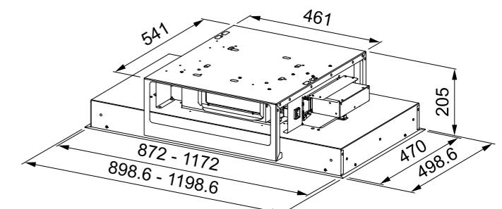
Maris Slim:necessita apenas de 21 cm de altura para instalação no tecto.
