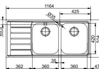
Nas instalações à face, é necessário perfurar o orifício e fazer o rebaixamento com base nas medidas/espessura do lava-loiças a instalar.
